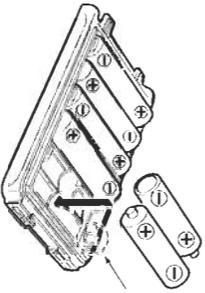
**ATTENTION !** Les bornes négatives du boîtier de piles dépassent du corps du boîtier et peuvent provoquer des blessures aux doigts lors de l'insertion des piles.
