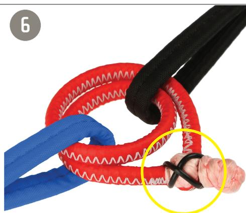
Twister le joint caoutchouc et repasser la autour de l'extrémité munie du noeud.
