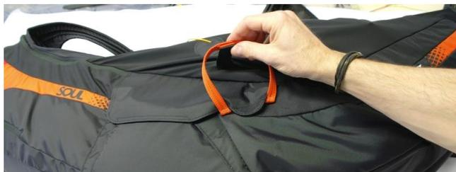
**!** Pour éviter l'ouverture accidentelle du système de secours, les goupilles fermant le conteneur doivent être vérifiées avant chaque vol!
