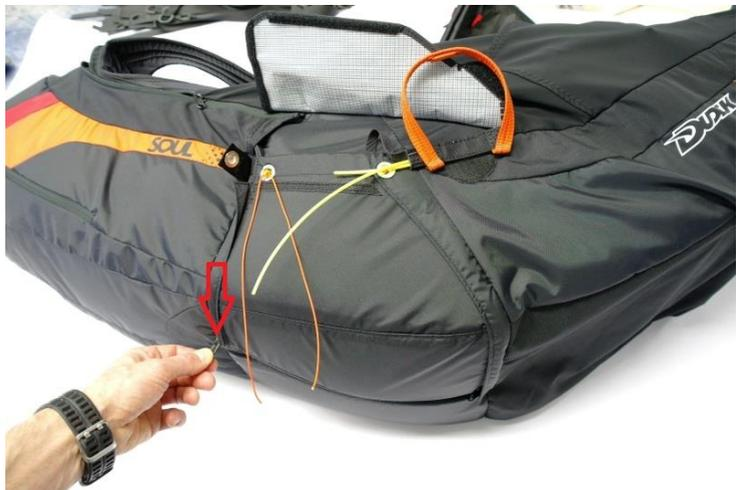
Laissez la ligne d'assistance au travers de la boucle.
