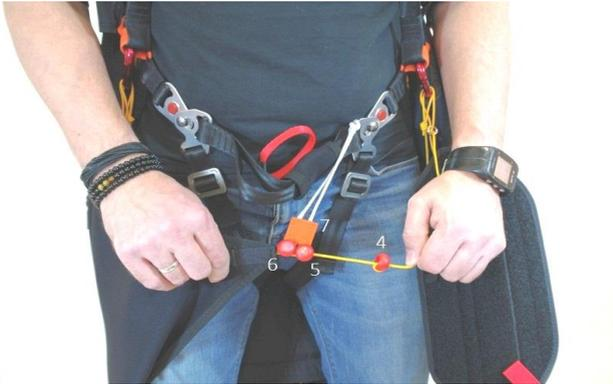
**!** Si la largeur du mousqueton a été modifiée, un réajustement de la fermeture du cocon peut être nécessaire aux points # 4 et # 8, ainsi que la longueur de la ligne supérieure gauche au point # 3.
